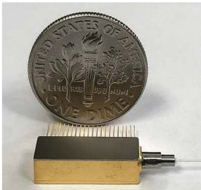
図2 SOA集積チューナブルレーザベーストランシーバは、通信デバイスに必要とされるスモールフォームファクタに適合するようにパッケージ化されている。米国の10セント硬貨との比較では、パッケージは長さ14mm、幅5mm、高さ4mmである。
