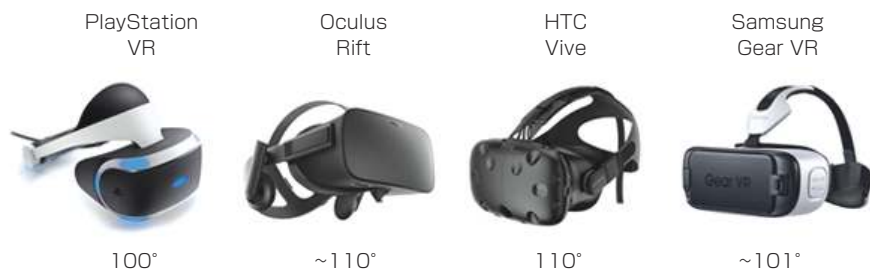
図1 さまざまなVRヘッドセットディスプレイの視野 (FOV) の比較。図に示されていない他のデバイスとしては、米グーグル社 (Google) の「Daydream」(FOV: 100°)、台湾HTC社の「Vive Pro」(110°)、韓国サムスン社 (Samsung) の「Odyssey」(110°)、米デル社 (Dell) の「Visor」(110°)、中国レノボ社 (Lenovo) の「Explorer」(110°) などがある。
