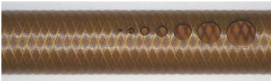
図3 超短パルス(UPS)ファイバレーザー加工により、金属・ポリマー層の素材から構成されるカテーテルチューブに穿孔できる。(提供:ブルーエイカー・テクノロジー社)
