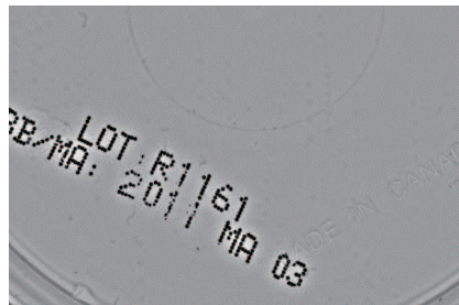
図5 図3の4枚のソース画像を用いたアルベド解析により、印字を強調することができる。
