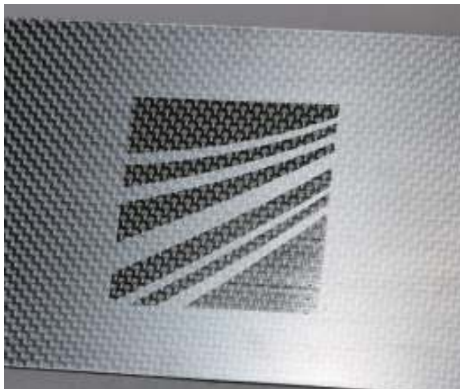
レーザ照射によりCFRP上に形成されたフラウンホーファーIFAMのロゴ。
