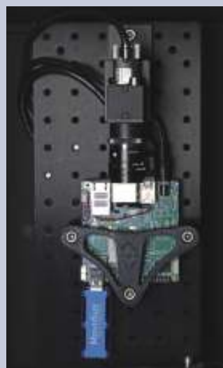
図1 システムをテストするために、フリー社のエンジニアは、産業用カメラ、AAEON社のシングルボードコンピュータ、インテル社のMovidius Neural Compute Stickを使用した。
