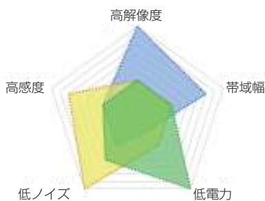
図1 アプリケーションが求める要求に対してイメージセンサの各特性のバランスを調整する必要がある。
