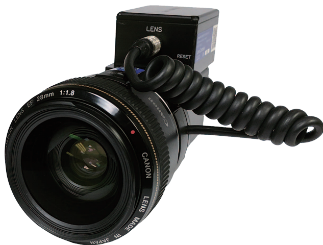
図4 非互換のカメラとともにEF規格を使用したいと考えるシステムインテグレーターは、ISSI社が提供するCanon EFレンズコントローラなど、独立したレンズコントローラを利用することもできる。
