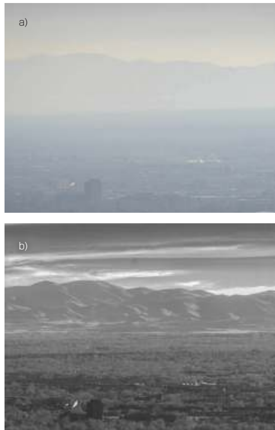
図 1 ユタ州ソルトレイクバレーでは、大気汚染を一度に数日あるいは数週間トラップする大気現象が時折起こることがある。こうした大気逆転が起きている間、地表の可視性は非常に低下する。ビデオで撮ったこれらの画像は、可視画像 (a) と短波長赤外 (SWIR) 画像 (b) を示している。2017 年 12 月 7 日 3:30pm 山間部時間ごろ ( https://youtu.be/3cBkfQb8vxQ 参照)、地表の可視性が極めて低い間の画像である。SWIR 画像は、センサーズ・アンリミテッド社の GA1280JSX mini-SWIR エアリアカメラと 200mm SWIR 最適化 f/1.6 レンズを用いて 60fps で撮った。可視画像は、Nikon D5100 DSLR カメラのビデオモード、55 ~ 200mm f/4.5 - 5.6 レンズで撮った。両画像ともトリミングしているが、他の方法での変更はされていない。(提供: センサーズ・アンリミテッド社)
