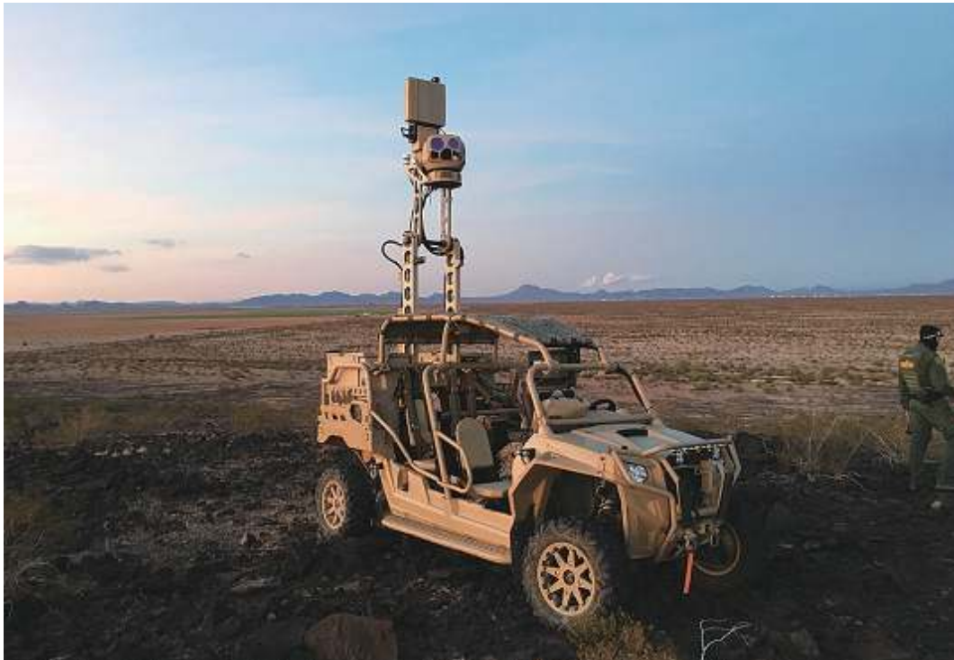
図2 このフリーア社製軽量戦術偵察および観測車輜、LTV-Xは、相補型センサアレイを搭載している。これにはNIR、SWIR、サーマル、レーザ式測距およびレーダーが含まれる。(提供:フリーア社)
