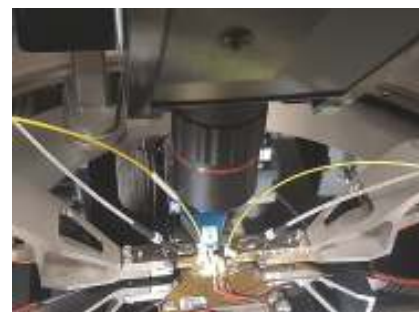
図2 シリコンフォトニクスコンポーネントは、リアルタイムで位置決めされ、プローブされる。
