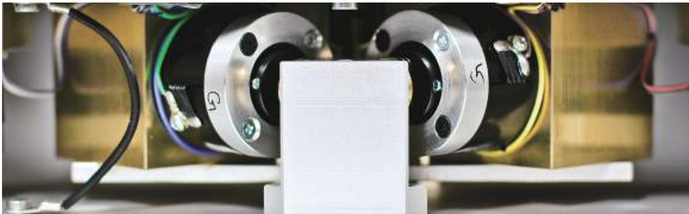
図3 アクティブ振動制御システムは、圧電センサ、アクチュエータ、および制御エレクトロニクスを使用して、動的に環境の振動に対処し、上板に位相が異なる逆の力を加える。
