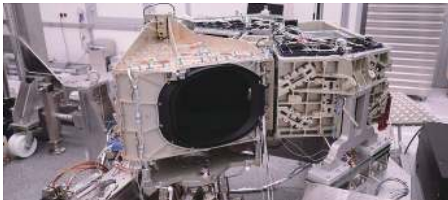
図3 シメトリー社の「ZONDA」ヘキサポッドは、インバー材とリニアアブソリュートエンコーダの採用によって、高い熱安定性が実現されており、宇宙用光学計測器の校正によく使われる。写真は、OHBシステムズ社向けに開発した製品である。OHB社はEnMAPの主契約業者として、ドイツ航空宇宙センター (DLR: German Aerospace Center) と契約し、独経済エネルギー省 (German Ministry for Economic Affairs and Energy) の助成を受けている (整理番号: 50 EP 0801)。(提供:シメトリー社)
