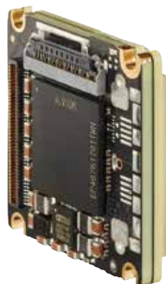
図2 アライドビジョン社の「1」シリーズのカメラモジュールには、オンボード・プロセッサが搭載されており、搭載用カメラよりもコンパクトな設計となっている。
