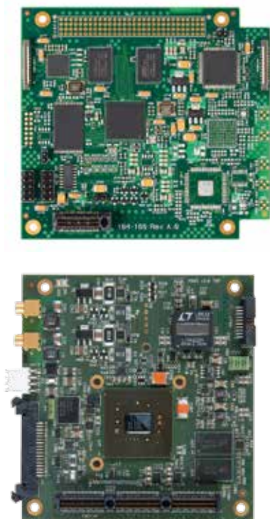
図3 (a)アドバンスド・マイクロ・ペリフェラルズ社の「HDGrabberX」シリーズのボードには、最新世代のPCIe/104規格が採用されており、HDMI/DVI、RGB、HD-SDI信号のキャプチャに使用できる。(b)一方、ユレシス社は、CXP規格をサポートするボードをマシンビジョン市場向けに提供している。
