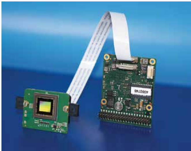
図5 ビジョン・コンポーネンツ社の「VCSBC Nano Z OEM」ボードレベル・スマートカメラは、LinuxベースのOSを搭載しており、ユーザーはOpen CVで独自のアプリケーションを開発するか、HALCONをベースとするマシンビジョンライブラリ「VC LibQ」を使用することができる。
