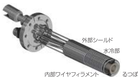
図2 有機EL金属陰極薄膜の蒸着プロセスに使用される、一般的な蒸着セル。ワイヤフィラメントと円筒形のるつぼで構成される。
