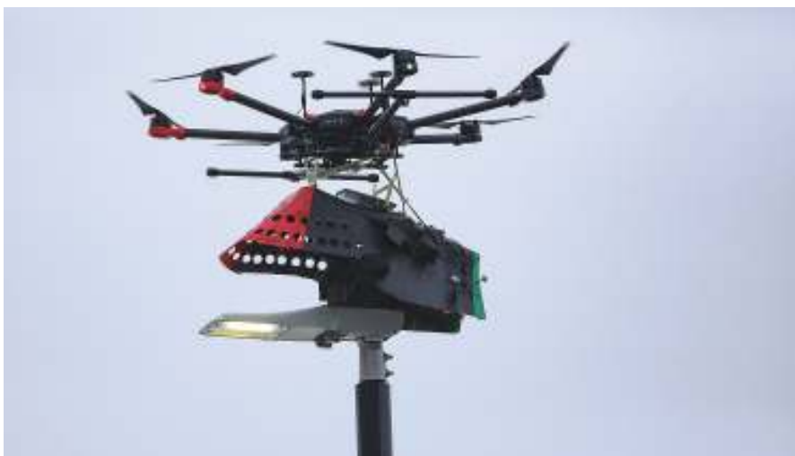
図7 Strihl社は、街路照明の修理や改築時に、バケツトラックの必要性を排除可能なドローンプロトタイプで注目を集めた。
