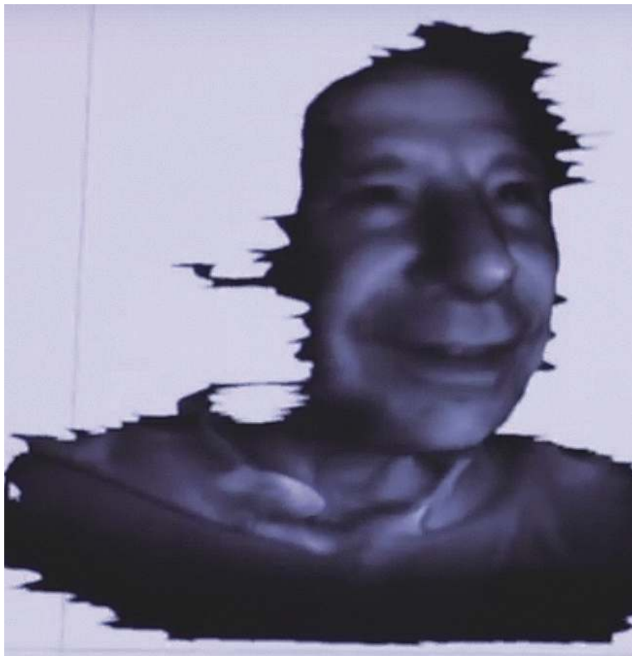
図1 TOFイメージングは、顔認識に極めて重要な深度値を付加し、これによって実際の3D 顔面が同定され、平坦な2D 写真やビデオでないことを保証する。(提供:エスプロス社)
