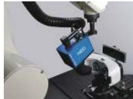
ガンマ・サイエンティフィック社は、ニア・アイ・ディスプレイのQualified Viewing Space (QVS)特性を評価するための世界初の高精度装置を提供している。GS-1290 NEDは、仮想現実や拡張現実用のデバイスや、ヘッドアップディスプレイを対象に、人間の目によって認識される色とコントラストを高空間分解能で測定することができる。オートコリメータカメラ撮像システムと、 $0.1^\circ \sim 5^\circ$ の高精度スポット分光放射計を搭載し、輝度、色、コントラスト、均一性、スペクトル透過率、応答時間、フリッカ、MTF、左右の目の視差などのデータを出力する。
