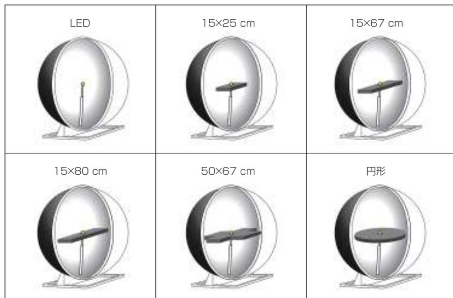
図2 さまざまな照明器具のサイズと形状をシミュレーションするために、テストで使用したDUTの種類
