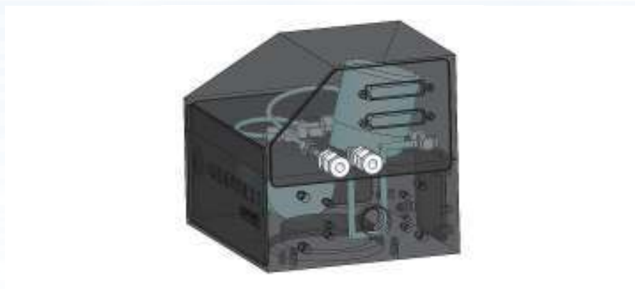
図2 スキャニングシステム用の水冷却回路の例。
