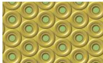
図1 フィリップスフォトニクス社 (Philips Photonics) のハイパワー VCSEL アレイは、六角形パッキングおよび金接点で囲まれた多数のレーザー開口で構成されている。(提供: フィリップスフォトニクス社)
