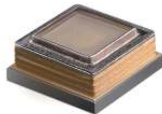
図4 VCSELアレイは、光学素子とともにパッケージに気密封止されている。(提供：フィリップスフォトニクス社)
