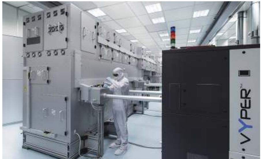
図4 コヒレント社の新しい「LineBeam1000/TwinVYPER」システムでは、4本の独立したレーザーからの出力をシステム内で結合して、1本のラインビームを生成する。
