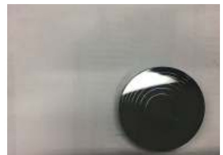
図3 この写真は、シングル切断工具を使ったパート18の加工表面を示している。
