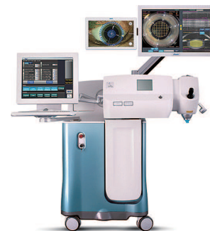
図1 アルコン社のLenSxは、世界中の白内障手術で、ほかのどのフェムト秒レーザーよりも多く使用されており、2017年には100万回の手術に使われた。このシステムは白内障手術を自動化し、ガイド役として高解像度のOCTイメージングを作成する。(提供:アルコン社)
