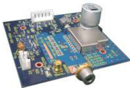
図2 ピーク電流150A短パルス駆動LDドライバ、パルス幅:30ns(電流、パルス幅をカスタマイズ可能)、繰り返し周波数:5kHz、対応LD:CANパッケージ(様々な帯域、ピンアサインに対応) 基板サイズ:60×60mm、主な用途:水中ライダ。
