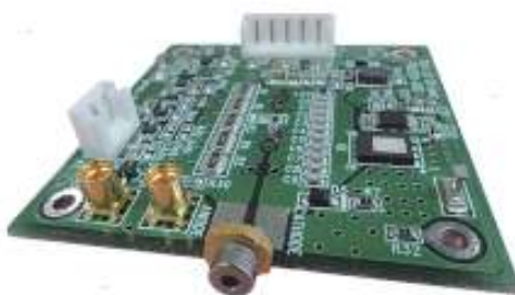
図1 水中ライダ向け開発で最初に製品化した70A短パルス駆動レーザダイオードドライバ。パルス幅15ns、ピーク電流70A、繰り返し周波数20kHz。用途はライダ光源だが、その他にレーザ加工機光源、分析用光源にも適用可能。現在、最も多く採用されているのはロボットの位置制御用途。
