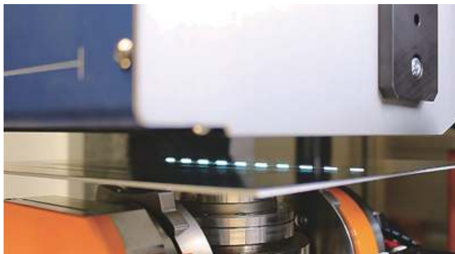
図3 RAZipol(www.razipol.eu)、ヨーロッパ人の取組みの狙いは、放射状および方位角偏光のビームを使ったレーザ材料加工の効率的な利点の研究である。ここではNext Scan Technology/Scanlabによるポリゴンスキャナが、ラフ・オン・ア・チップ加工向けにサブピコ秒パルスビームでパターンを作成する。(提供:RAZipol/Next Scan Technology社)
