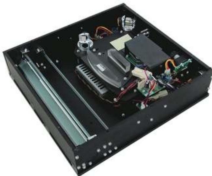
図4 日本電産コバル電子のスキナシステムは、ポリゴンレーザミラー(黒い側板)とfシータレンズを収容し、直線速度スキナする。fシータレンズ素子は、円形レンズ素子の薄片として作製することができることに留意、スキナそのものは1次元のみ。(提供:日本電産コバル電子)
