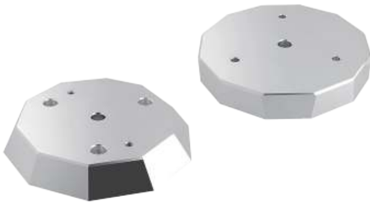
図5 2つの異なるタイプのポリゴンミラーを示している、いずれもII-VI Infrared社製。ピラミッド型(左)とイレギュラー型(右)。イレギュラーミラーは、面が交互に異なる方向に傾いており、2つの異なる場所にラインスキャンする。(提供:II-VI Infrared社)
