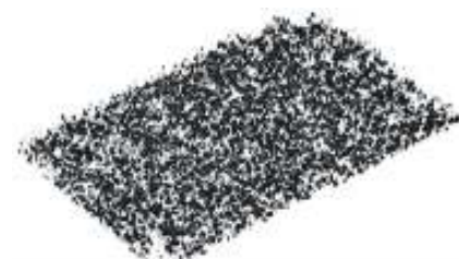
図1 車の塗装の3D OCTイメージをキャプチャした後、金属フレークが自動的に「抽出」され、ソフトウェアのアルゴリズムを通じて計測される。塗装された車のパネルの一部である2.25mm×1.4mmから抽出された数千のフレークをイメージングした。(提供:リバプール大のブライアン・ウィリアムズ氏[Bryan Williams])
