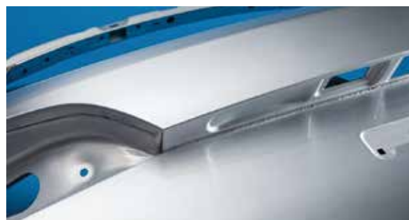
図3 「Audi Q5」のアルミニウム製テールゲートの外観部分にある溶接シーム。
