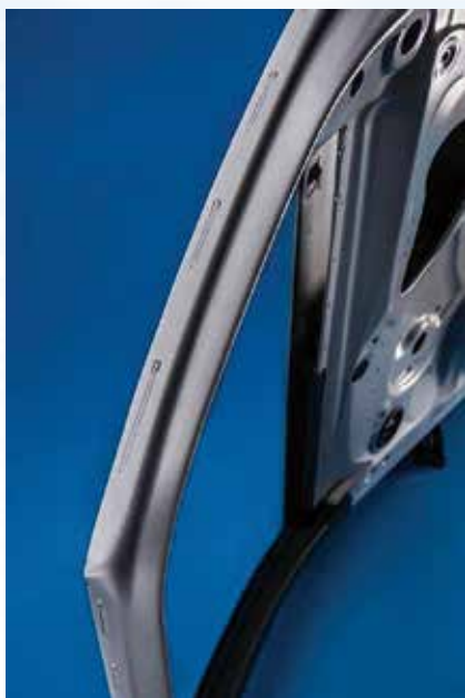
図4 「Audi A6」のアルミニウム製ドアのステッチおよび隅肉溶接。
