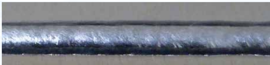
図5 用途に合わせた3スポット形状で、5xxxアルミニウム試験材にリニアエッジ隅肉溶接した結果。
