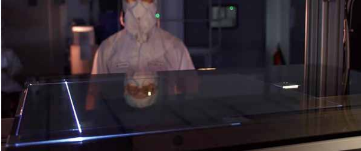
図2 フレキシブルディスプレイのレーザーリフトオフ加工の際、キャリアパネルはエキシマレーザーのラインビームの下を移動する。
