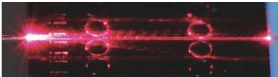
図4 マイクロコム作製用SiN集積マイクロキャビティ(提供:EPFL、マイケル・ガイゼルマン氏)。
