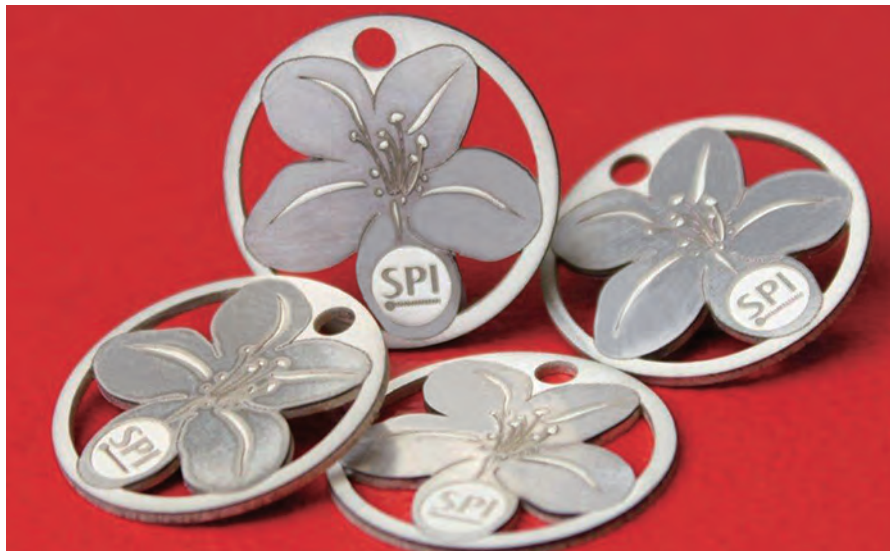
図3 ナノ秒パルスファイバレーザは現在、この図に示したユリのデザインを施した銀製品のような、精密な金属切断とテクスチャリングを実現するために、宝石業界で一般的に使用されている。
