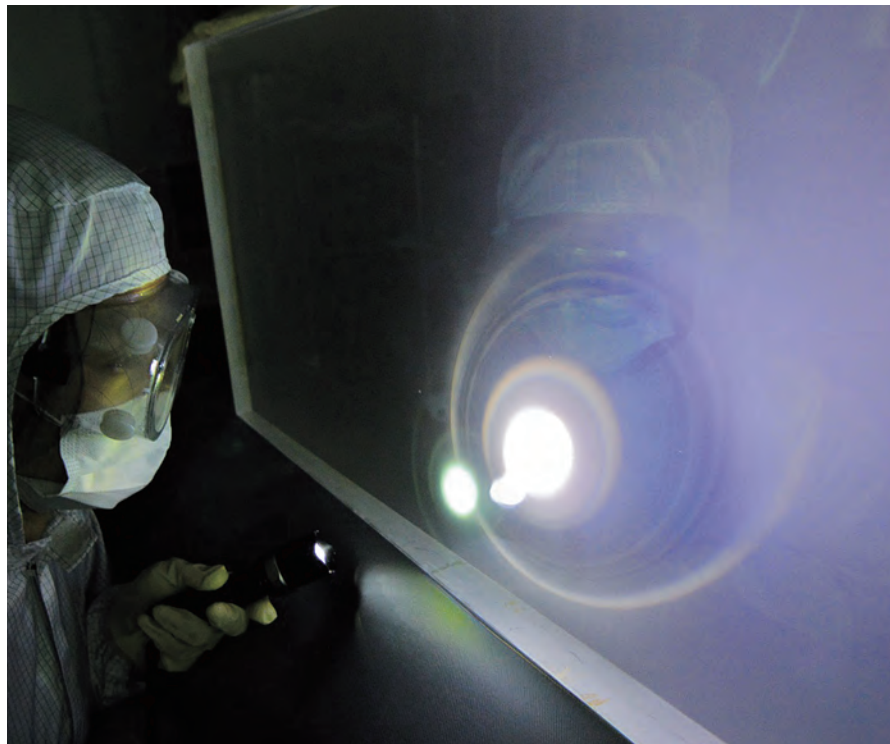
図1 SG II-UP向けの大開口偏光子(最大直径900mm)。
