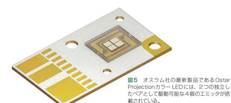
チップ構造で、チップ上面にn層があり、チップ下面にn層接合部と接続する導電性ビアの列がある。この構造によって、均等な電流分布と発光が得られる。電流密度を $3A/mm^2$ にすることが可能で、 $1mm^2$ のチップを3Aで駆動することにより、3.2Wの放射出力または830lmの蛍光体変換白色出力が得られるとパイラー氏は述べた。
