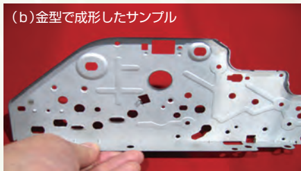
溶接前に治具による強固な固定が必要
