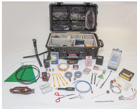
図1. トラブルシューティング・キットの主な工具や部品。スペクトラムアナライザは、測定周波数範囲 10 MHz ~ 6 GHz の Thurlby Thandar 社製モデル PSA6005 である。全ての工具や部品は、Pelican 社製の運搬用ハードケース 1514（キャスター付）内にぴったり収まる。中身については本稿のパート1とパート2で記述する。
