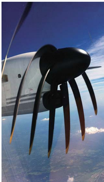
図5 全ピクセルが同時に露光される電子式グローバルシャッターを装備する高速ビデオカメラではなく、ピクセルが1ラインずつ露光されるローリングシャッターを採用するカメラで撮影すると、航空機のプロペラ翼が垂れた画像が得られてしまう(提供:フォトロン社)。
