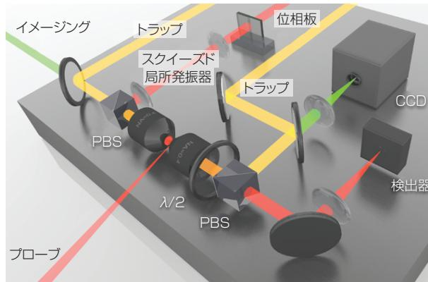
図1 酵母細胞内の細胞内構造を追跡し、画像化するための実験装置は、局部発振器からの振幅スクイーズド光とプローブ光源を使用する。粒子はトラッピングフィールド(黄色)によって操作され、イメージングフィールド(緑)によってCCDカメラ上に可視化される。PBS=偏光ビームスプリッタ;  $\lambda/2$ =半波長板。(資料提供: クイーンズランド大学)
