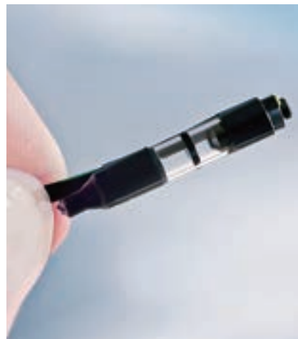
複雑な形状のキャビティを測定するためのこの小型視覚化システムは、直径わずか3.6mm、長さは20mm弱である。18個以上の光学素子を搭載し、直径1mm未満の複数のレンズを採用する。(写真提供: フィスバ・オプティック社)
