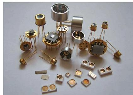
図1 LEDマイクロセンサー社の中赤外デバイス
