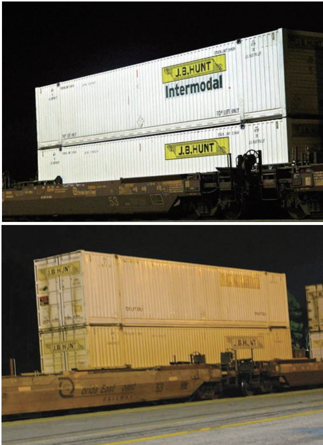
図4 LED(上)とHPS(下)をそれぞれ採用したハイマスト照明の比較。
