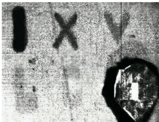
図1 この画像はポリエステル織物上に希釈度の異なる血液で書いた文字「I(希釈なし)」、「X(10倍に希釈)」、「V(25倍)」、「L(50倍)」および「C(100倍)」を示している。画像はAC(交流)変調反射の同相検出を用いて再生された。右下には位相検出の参照物体がある。(許可を得てAnalyt. Chem., 82, 8427-8431; Copyright 2010 American Chemical Societyから転載した)
