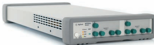
図1 光スイッチはN7731A(デュアル1×4)(図)、N7734(1×13)の2種類。光スイッチが追加されたことで測定の自動化、測定時間の短縮が一段と進む。例えば、1×4のスイッチを使用してPON用の波長(1310nm、1490nm、1550nm、1625nm)を切り替えながらデバイスのテストをすることができる。
