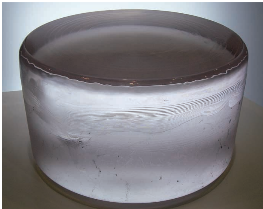
図1 サファイア結晶のブール 直径は15インチ
