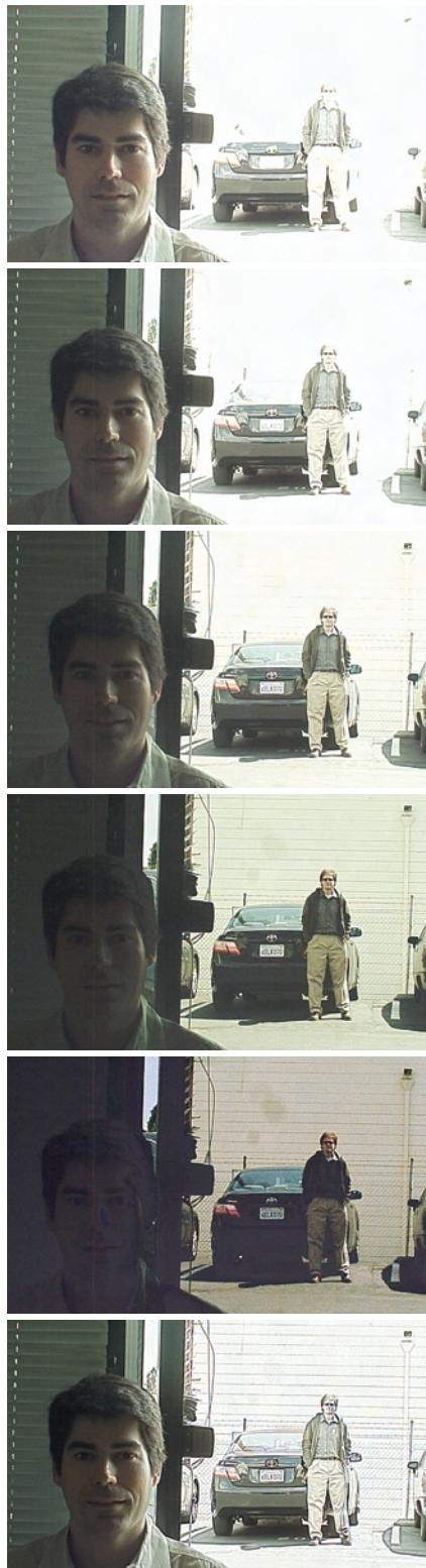
**図2** 多重画像から融合されたHDR画像を示している。上から5番目までは従来の単一露光による画像であり、最後はフォルツアシリコン社が試作したHDRセンサと実時間トーンマッピングシステムによるトーンマッピングHDR画像である。(資料提供:フォルツアシリコン社)
