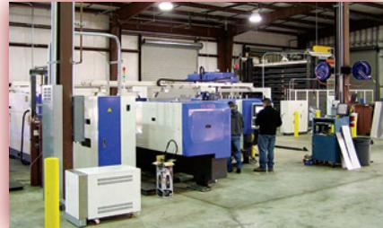
図4 Han-Kwang社のプレートレーザとタワーオートメーションが導入されている。
