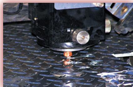
図5 自動車製造用ステップ鋼板のレーザ・テクスチャリギ。
