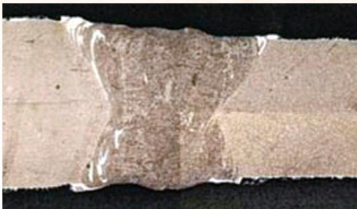
図1 汚染された溶接部。
