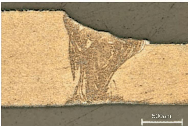
図2 汚染された溶接部。
