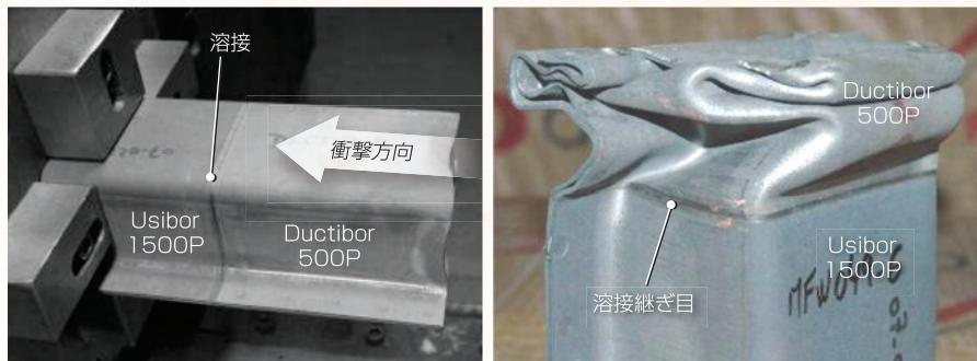
図6 Al-Si被覆PHS Usibor/DuctiborのアブレーションしたLWB安全溶接継手の衝撃試験。
