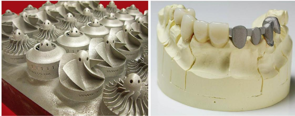
図2 高出力レーザを使用しプラスチックまたは金属の粉体を層ごとに融解して、特注の航空機用タービン部品(左)と歯科用インプラント(右)がCADモデルから直に作製されている。(資料提供:3T RPD社)
